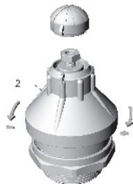
**Regolare la pressione sulla molla, ruotando la campana di regolazione (2). Ruotare in senso orario per aumentare la pressione, ruotare in senso antiorario per diminuirla. Durante tale operazione non è necessario mantenere ferma l'asta con il cacciavite, in quanto la spinta della molla è sufficiente a non fare ruotare l'asta stessa**
